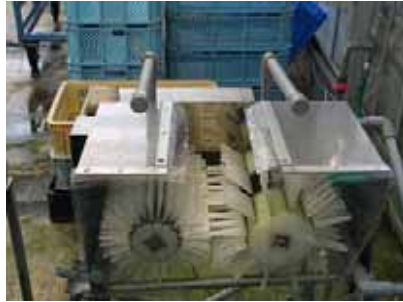
プロペラ状のはけが回転し、トレイを1回差し込むだけで水洗い作業が完了する。
