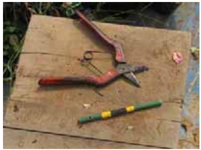
目安棒は、棒にビニールテープを巻き、色で長さがわかるように工夫している。
