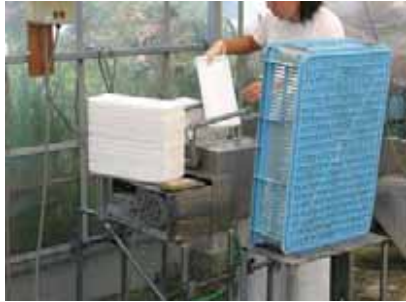
出荷調整に使用するスチロール製のトレイを水洗いするために開発した専用機。
