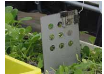
作業をする人に対して直角にカミソリの刃が固定されており、水耕野菜（事例はチンゲン菜）の根っこ部分を落とすだけで根切りができる。
