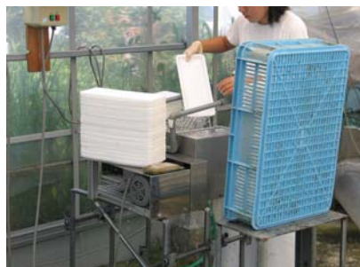
上の管から水が流れており、機械の中にトレイを挿し込むだけで、きれいに洗浄できるように作られている。
