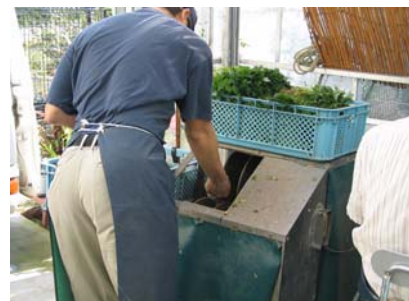
プロペラを回して、ミツバの下葉と根を取り除いている男性従業員
