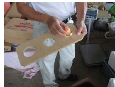
穴に通すだけで、タマネギの大きさの選別ができるように工夫した板
